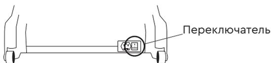
9. Нажмите кнопку
