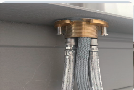
3. Вставьте смеситель в круглое отверстие раковины, подключите холодный и горячий водопровод, а также трубку для утяжеления и зафиксируйте смеситель.
